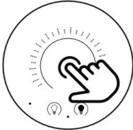
3x die Haupttaste des ausgeschalteten Moduls drücken
